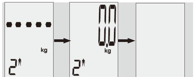
Die Waage schaltet automatisch ab.
